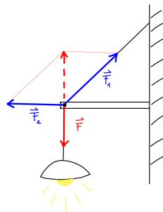
Sei  $F$  die Gewichtskraft der Lampe. Dann ergeben sich die Zugkraft  $F_1$  am Seil und die auf die Schiene wirkende Druckkraft  $F_2$  aus dem in der obigen Abbildung
